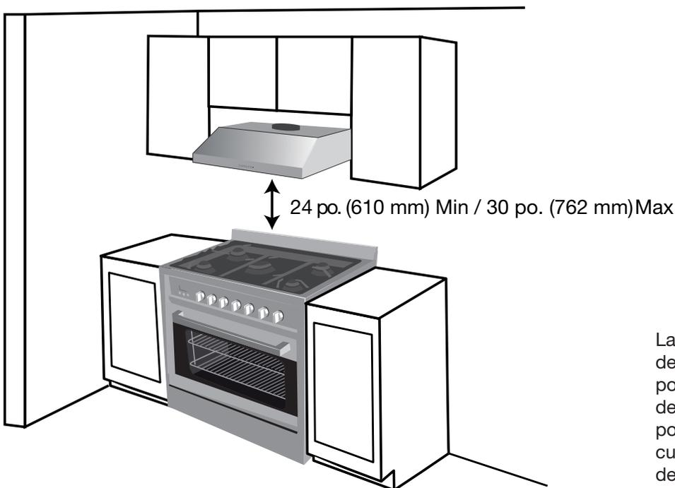
La distance minimale entre la hotte et la table de cuisson ne doit pas être inférieure à 24 pouces (61 cm). Il est fortement recommandé de maintenir une distance maximale de 30 pouces (76 cm) au-dessus de la table de cuisson pour capturer au mieux les impuretés de cuisson. Les distances supérieures à 30 pouces sont à la discrétion de l'installateur et de l'utilisateur.
