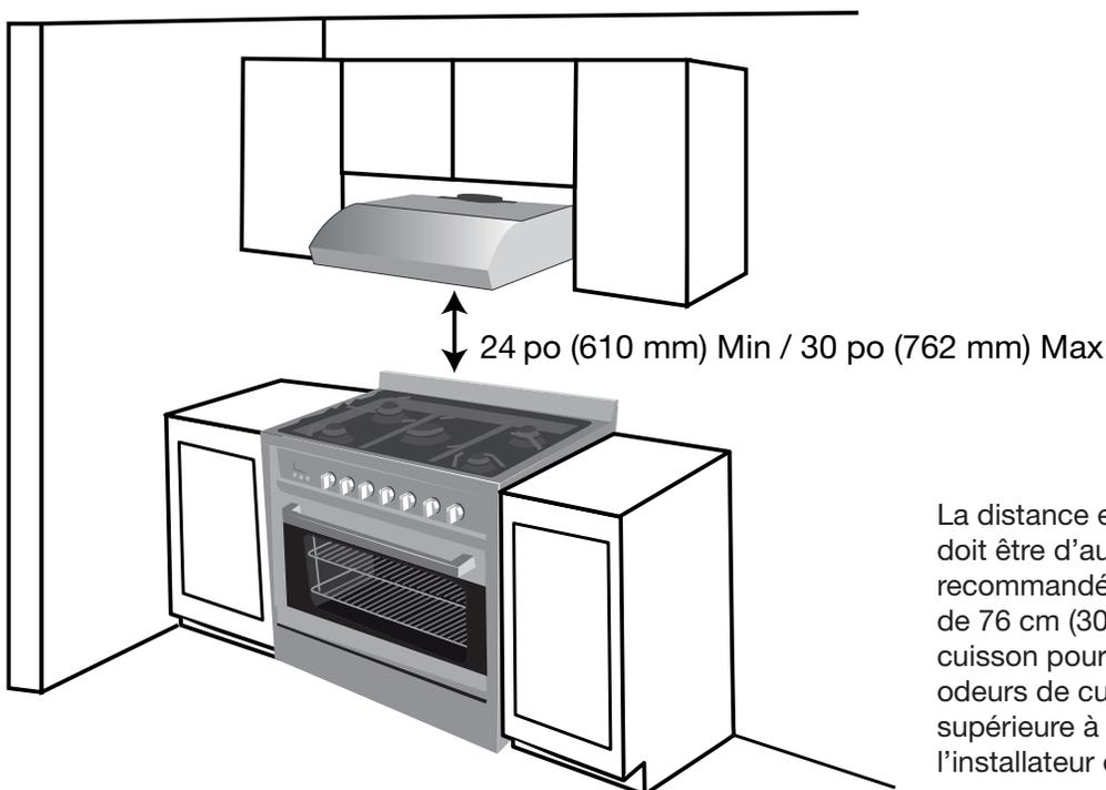
La distance entre la hotte et la surface de cuisson doit être d'au moins 61 cm (24 po). Il est fortement recommandé de ne pas dépasser une distance de 76 cm (30 po) entre la hotte et la surface de cuisson pour assurer une meilleure captation des odeurs de cuisson. L'installation à une distance supérieure à 76 cm (30 po) est à la discrétion de l'installateur ou de l'utilisateur.
